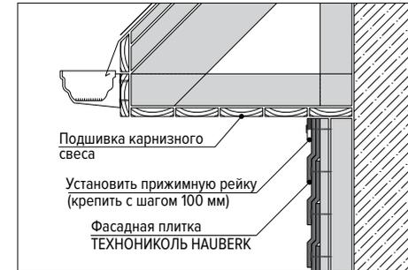
Рис. 9.2. Монтаж верхнего ряда под карнизным свесом
