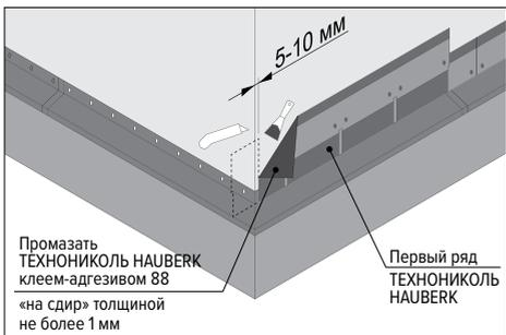
Рис. 4.2. Монтаж второго и последующих рядов фасадной плитки
