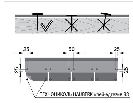
Рис. 1.1. Схема крепления фасадной плитки
