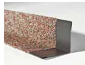
Материал: в основе высокопрочный стальной лист толщиной 0,45 мм, покрытый с обеих сторон алюмоцинковым сплавом, снаружи покрытие из натурального базальтового гранулята.
