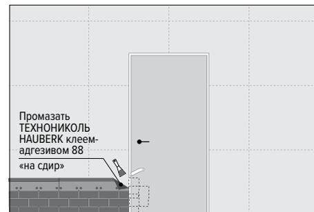
Рис. 7.1. Монтаж фасадной плитки вокруг дверных проемов
